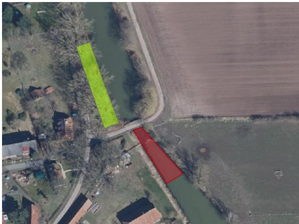
3 Maßnahmen Karte, rot = Entnahme, gelb = Anlagerung 4 Anlagerungsbereich
